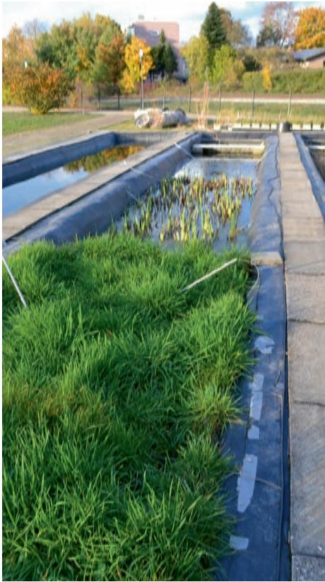
In langwerpige bassins wordt onderzoek gedaan naar een natuurlijke vorm van waterzuivering
